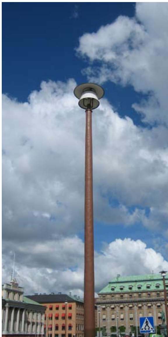
Bild 16. Norrbrostoppe, svagt konisk, gjutjärn. Ljuskällan är högtrycksnatrium. Foto Jan Garnert 29 maj 2006.
